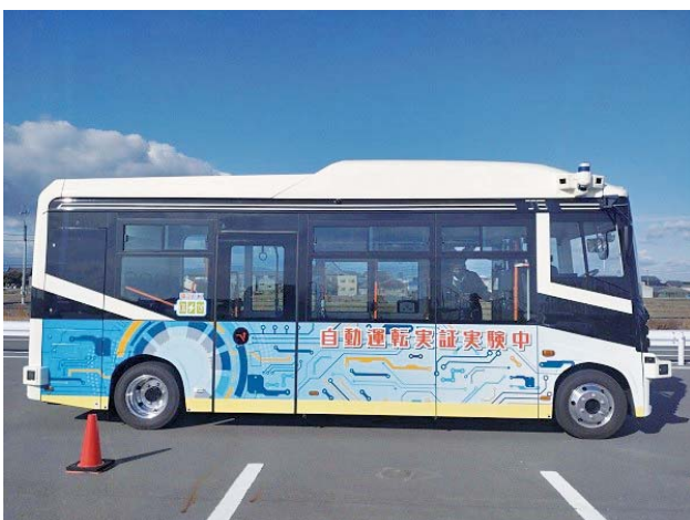
BYD製EVバスを自動運転用にチューニングした車両
