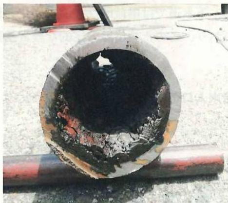
写真1 約70年使用された配水管の切断面
