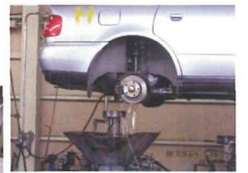
(廃ガソリンは、タンクに穴を開け排出。)
