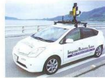
MMSによる被災堤防計測
