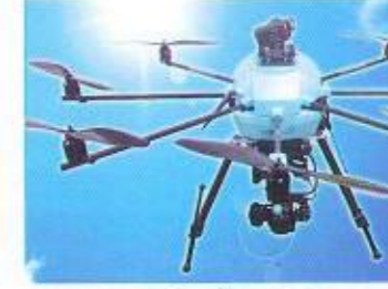
UAVによる堤防被災箇所の把握（メイン） UAVによる土砂災害調査（いなべ）
